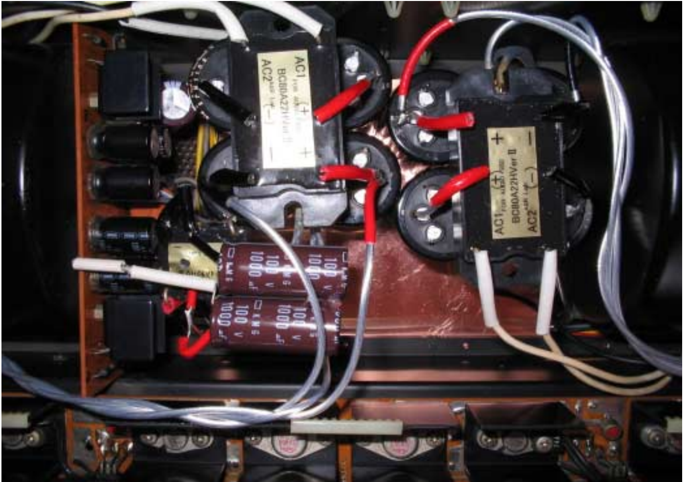
LUX 5M-21 大きな60V 15,000 \mu Fを取り外し、小さなコンデンサ8本に置き換える。
