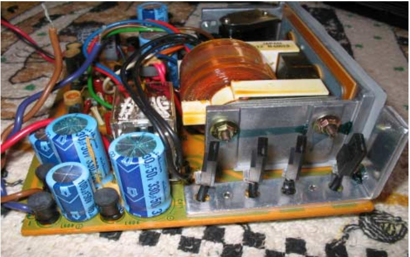
SW電源内部 2次整流Di FRD S 34をSBD(20A 200V) FCH20A20に変更
